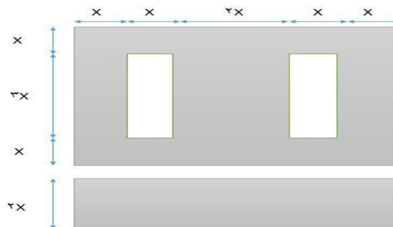
شکل ۲: ابعاد هندسی ترانسفورماتور (x=11 mm)
