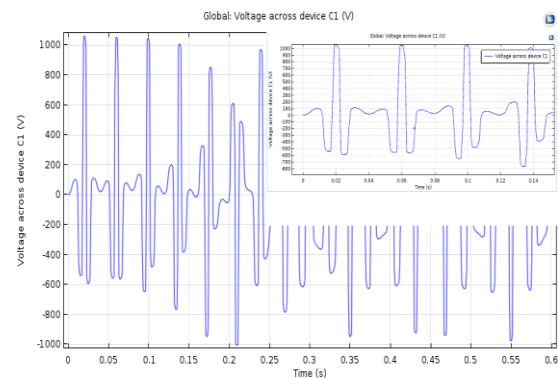
شکل (۱۴): منحنی ولتاژ حین وقوع فرورزناس با اثر بایاس DC
